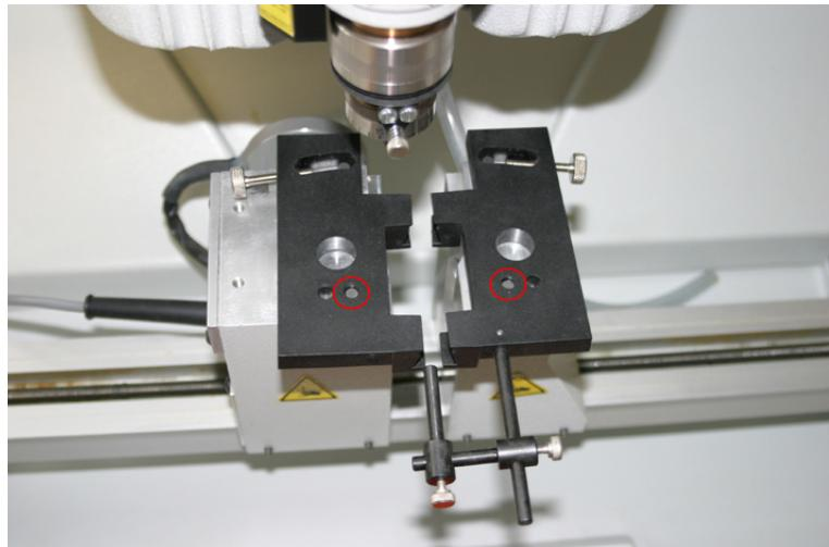
**1. Mit Stellring ( oben ) Druck anpassen. 5 mm**
